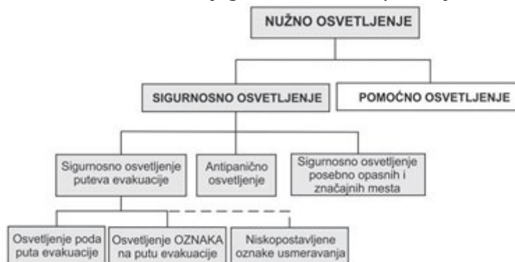
Slika 15. Podela nužnog osvetljenja prema EN 1838
